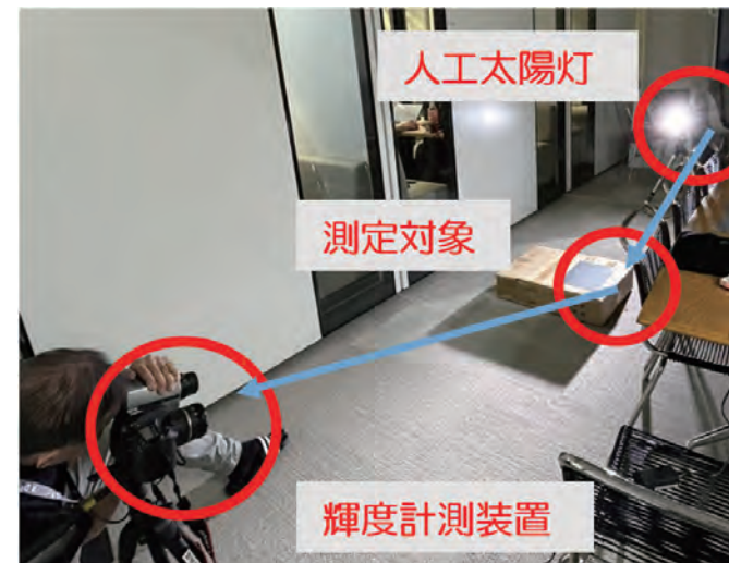
人口太陽灯による素材の反射光実測の様子（左図）と測定結果（右図）
