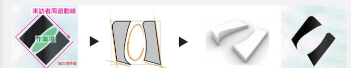
の手順を通じて、**定量/定性の双方向から解析**を行い、**建築の形態を決定**した。結果的に、卓越風を受け流す屋根形状によって**建築の裏に当たる風下にも既存以上の風量を確保**できた。
