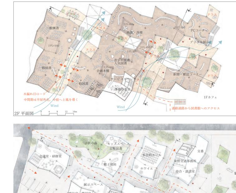
南風は高架の柱により東寄りの風に変化するため、線路に面したファサードから風を取り入れることで効率よく風を流せることがわかった。冬の北風は冷たいためできるだけ風速を抑えたいものの、完全に空間を閉じてしまうと通り抜け出来る半外部空間のコンセプトを失ってしまう。そこで、建築と連続性のあるデザインのランドスケープによって、「建築に引き込む」という意匠の効果と「北風の風速軽減」という環境面の二つの効果をもたらす駅前広場を設計した。
