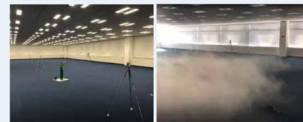
トレーサーガスによる検証 スモークによる気流の可視化
